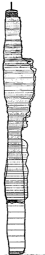
Figure 1. Profils verticaux superposés de la caverne #5 de Markham mesurés en mai 1995 et janvier 2002. Noter la montée du fond et les ruptures en paroi.
